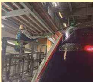
ボンネット洗浄
